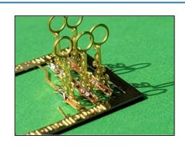
Nun kann man die verlöteten Halterungen leicht nach außen biegen und bekommt so eine perfekte Position für die Lackierung. Airbrush, oder Sprühdose – wir haben Letztere verwendet.
