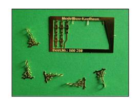
Im nächsten Arbeitsschritt werden diese gebogenen Halterungen mit der Wandhalterung verlötet. Dazu sollte man die Halterungen noch im umlaufenden Ätzrahmen lassen.
