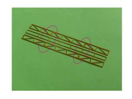
Die beiden stehenden Träger sind so konzipiert, dass die vier Teile auch nur gebogen werden müssen. Sie passen auch so noch in die Betongrundplatte. Das Gerüst ist so relativ einfach und schnell aufgebaut.
