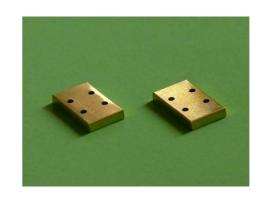
Die nächste Baugruppe ist die Traverse, oder Kabelträger über die Straße, nach seiner Fertigstellung ist er dreieckig. Wir trennen die Teile aus dem Ätzrahmen. Zum Zusammenbau kann er gelötet oder auch geklebt werden.
