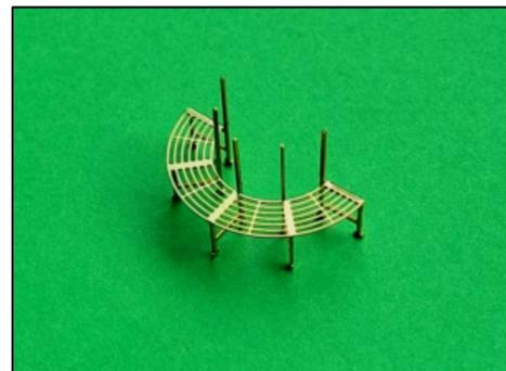
Im nächsten Arbeitsschritt wird die Rückenlehne aus dem Ätzrahmen gelöst. Sie soll nun in eine halbrunde Form gebracht werden. Hierzu eignet sich am besten ein 8 oder 9 mm Rundmaterial.
