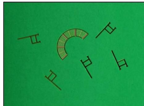
Die Sitzfläche hat an der Unterseite fünf Einkerbungen, in welche die Stützbeine jetzt mit Sekundenkleber verklebt werden.
